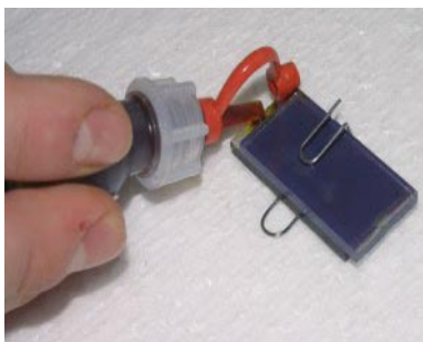
Figure 4 : Fabrication d'une cellule Grätzel
